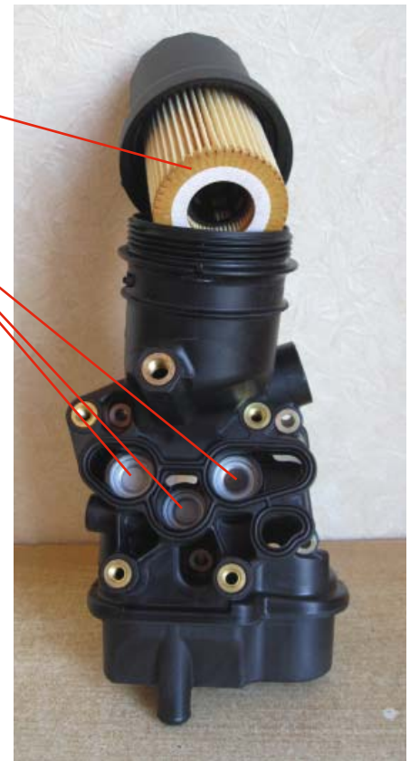
Масляный модуль компании MANN+HUMMEL со встроенными клапанами и заменяемым фильтроэлементом для Volkswagen и Audi. В настоящее время в Европе более 70% автомобилей производится с такими модулями и MANN+HUMMEL – один из лидеров в их производстве
