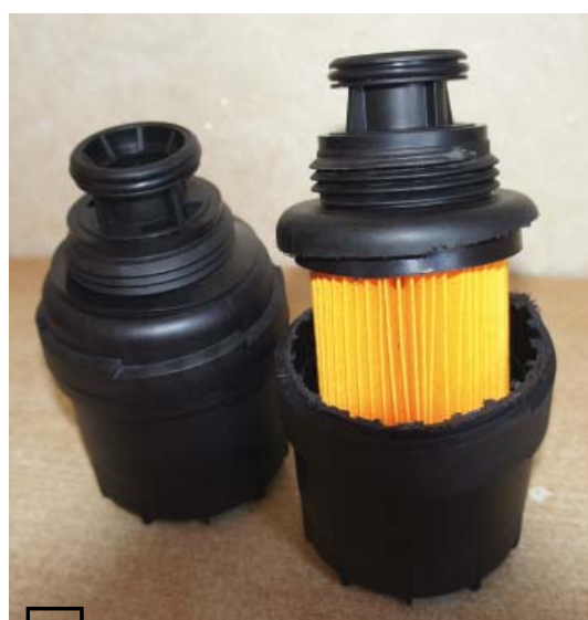
Некоторые производители выпускают неразборные масляные фильтры с пластмассовыми корпусами. Здесь показан фильтр дизеля Cummins, корпус разрезан.
