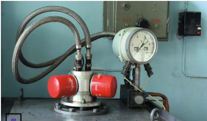
Испытание фильтра на пульсацию давления масла. За две секунды давление возрастает от нуля до 10 кгс/см 2 и тут же падает до нуля. Число таких циклов — 25 000
